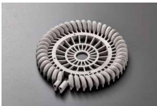
新鋼種 ADC12 造形サンプル
