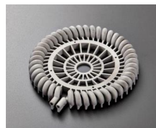
金属3Dプリンター造形 ADC12造形サンプル
