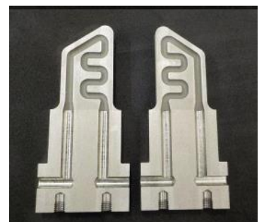
ハイブリッド造形による 三次元水管の入子
