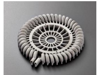
3Dプリンター造形品 ADC12 造形サンプル
