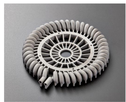
3Dプリンター造形品ADC12 造形サンプル（熱交換機）
