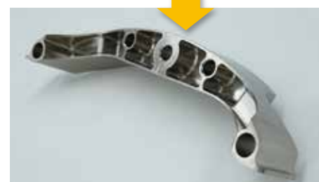
▲フレームをつなげる基幹部品/従来の板金加工から一体削り出しで高精度・軽量化に成功(材料S45Cを白銅が提供)
