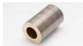
鉛フリー・スマス青銅合金です。JIS規格には、CAC906として登録されています。RoHS指令に対応している青銅で、鉛浸出量がほとんどないタイプの合金です。一般的な砲金(CAC406)と同等の機械的性質を有しており、Biを含有することにより切削性も確保しています。
