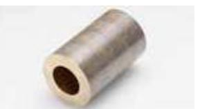
連続鋳造方法によって製造されています。砂型鋳物に比べ、急冷して鋳造されるため、組織が微細で、鋳造欠陥が少ないので特徴です。RoHS指令に対応した、カドミウムフリー、低鉛青銅合金となり、今まで一般的に使用されている砲金(CAC406)に代わる銅合金です。CAC406と同等の機械的性質、耐摩耗性、耐食性及び耐圧性を持ち、切削性はほとんど変わらずに加工が可能で、脱亜鉛腐食が無い製品です。
