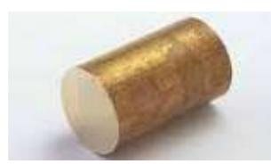
環境に配慮したカドミ(Cd)レス・鉛(Pb)レス黄銅合金です。鉛に代えてビスマスを添加し、カドミウム&鉛レスで従来材と同等の高い強度・優れた切削性・耐腐食性、また非磁性を実現しています。RoHS指令、ELV指令に対応しています。
